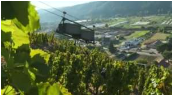
Figure 4. Transport de la vendange par câble en zone de terrasse avec une forte pente à Ampuis dans les Côtes-du-Rhône septentrionales, www.domaine-burgaud.com , photo www.groupe6.fr
