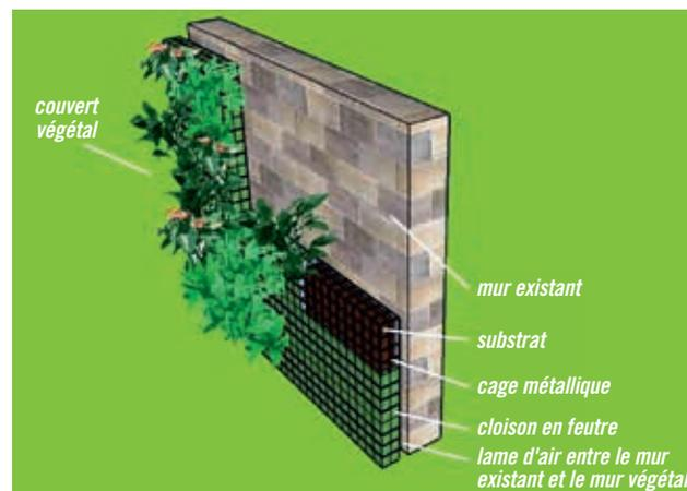
Schéma de principe d'un toit végétal (Illustration par Danny Aubin Source : [www.ville.montreal.qc.ca](http://www.ville.montreal.qc.ca)) et d'un mur végétalisé ([www.murmurevegetal.com](http://www.murmurevegetal.com))
