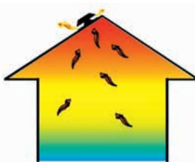
Variations de température selon la hauteur dans un bâtiment et exemple d'extraction d'air chaud sous toiture dans la région McLaren Vale en Australie.
